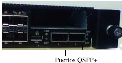
Ilustración 1. Panel frontal de Dell Networking N4000
